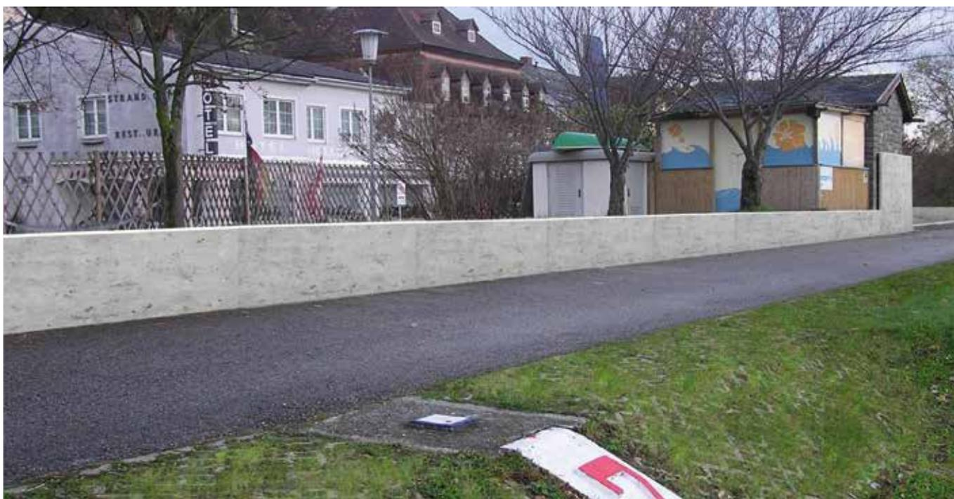
Diese Fotomontage zeigt die neue Hochwasserschutzmauer auf die im Bedarfsfall die Mobilwände montiert werden.
